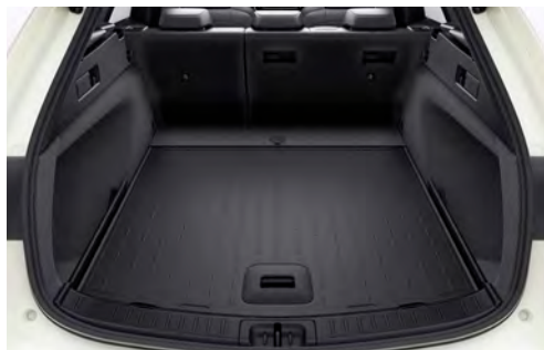
Vändbar golvskiva (vattentåliga sidan uppåt)
